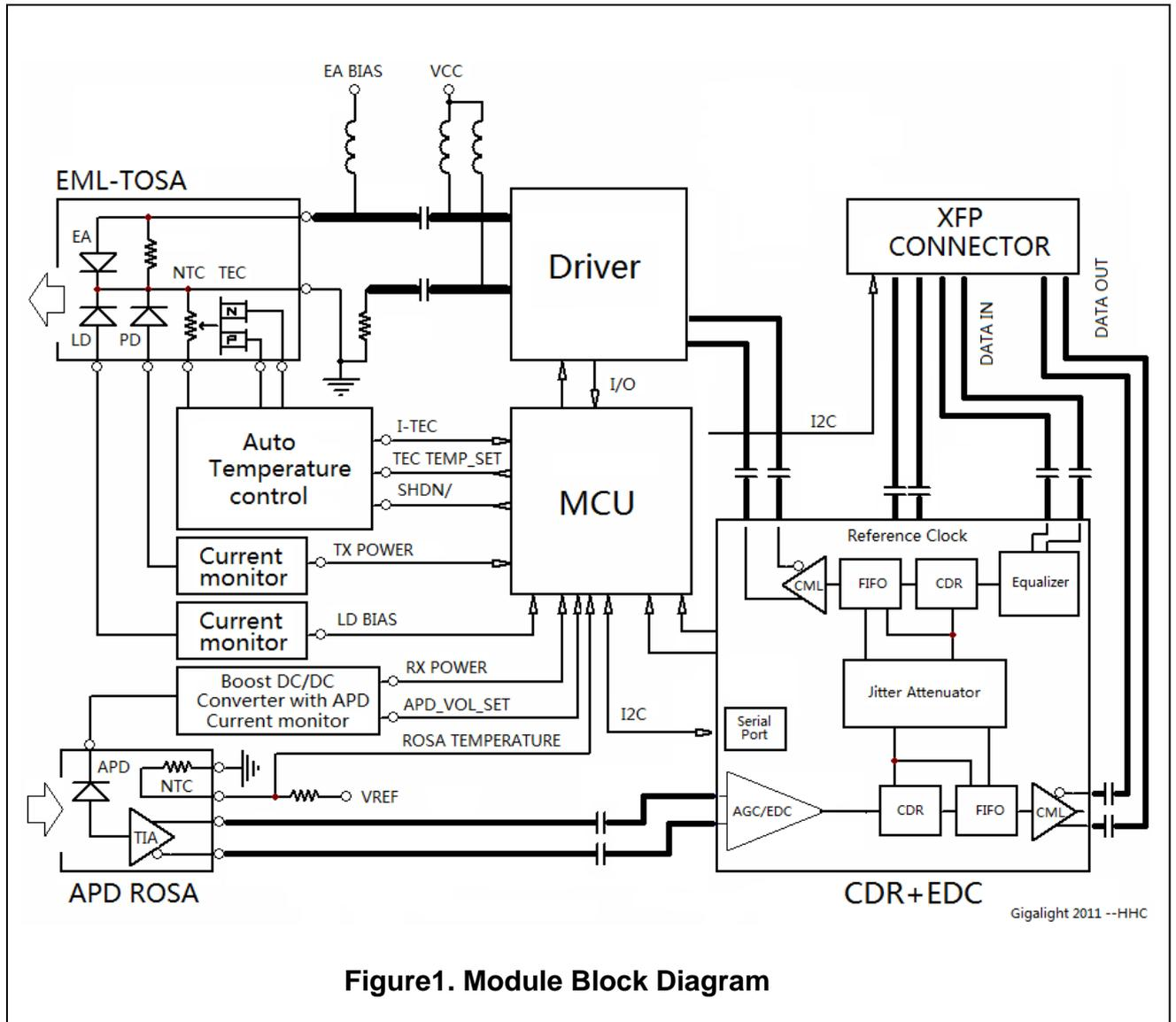
Figure1. Module Block Diagram
